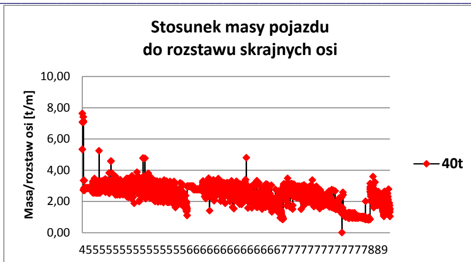
Rys. 5.22. Iloraz masy i rozstawu skrajnych osi pojazdów 40-tonowych
