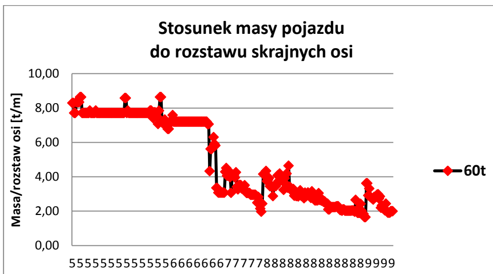
Rys. 5.24. Iloraz masy i rozstawu skrajnych osi pojazdów 60-tonowych
